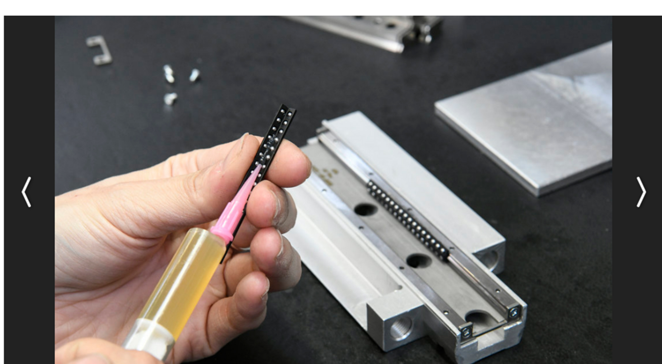
2/4 Die Schneeberger AG ist eine von sechs nominierten Firmen für den Unternehmerpreis Prix SVC. Hier werden Kugelleiter für die Umlaufkörper geölt. Bild: Thomas Peter
