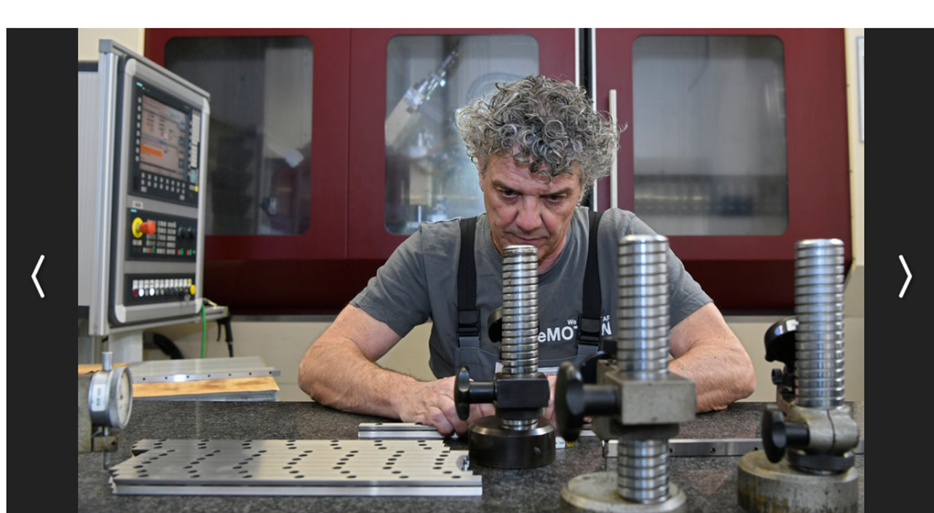
3/4 CNC Operateur Daniel Flury macht Qualitätsmessungen bei den Linearführungen. Bild: Thomas Peter
