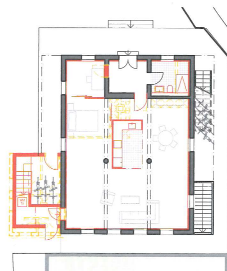
In der Erdgeschosswohnung dominieren die zwei Stützen in der Mitte des ehemaligen Klassenzimmers. Dazwischen liegt heute die Küche.
